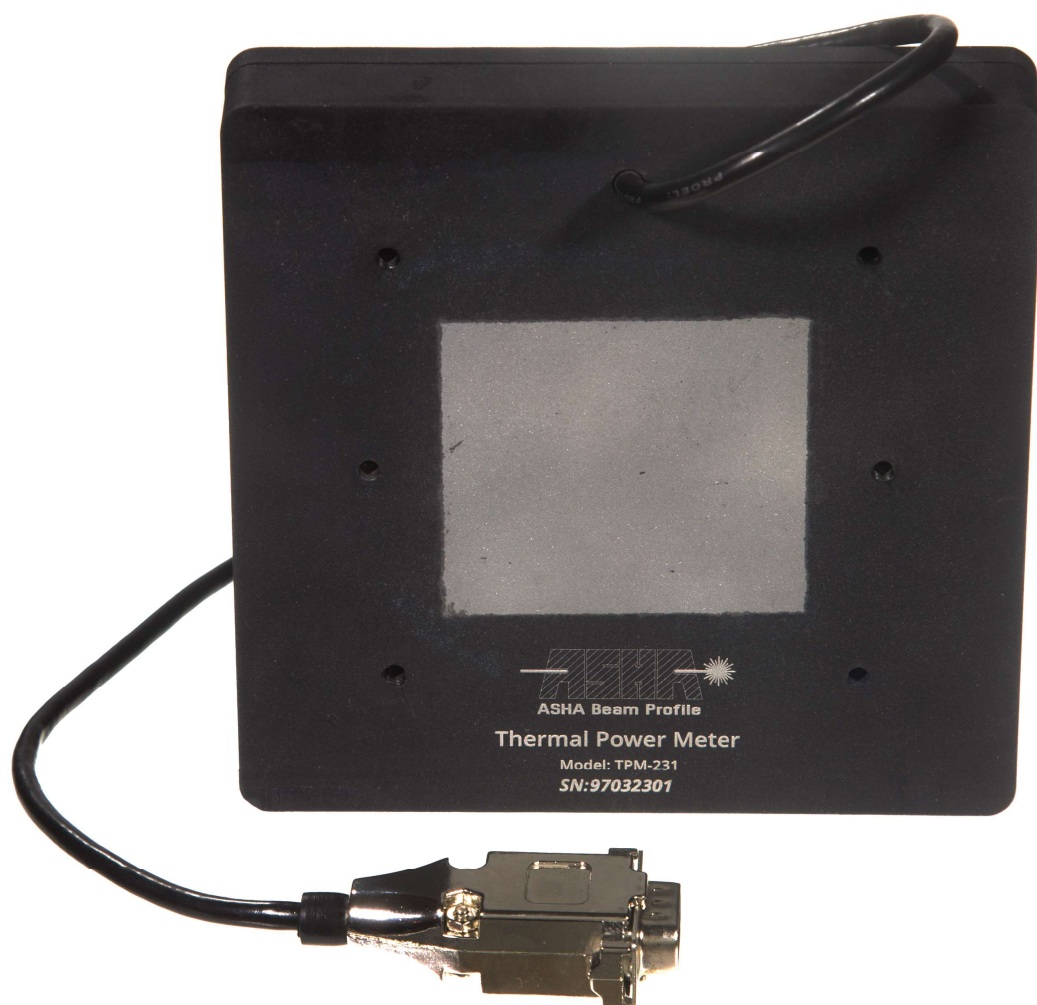
شکل ۲. حسگر توان سنج ۱۰۰۰ وات - نمای پشت
