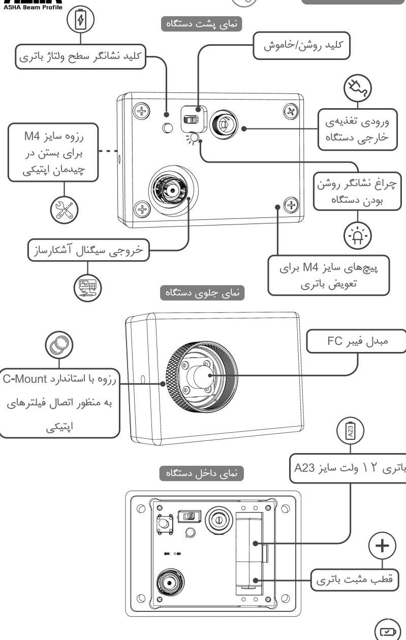
این دستگاه مجهز به قابلیت پایش باتری به منظور نمایش میزان ظرفیت آن می‌باشد. بدین منظور زمانیکه خروجی دستگاه به ولت‌متر یا اسیلوسکوپ متصل است، کلید نشانگر ولتاژ باتری را فشار دهد. با توجه به رابطه‌ی زیر، ولتاژ باتری را حساب کنید. باتری‌های A23 زمانیکه به ولتاژ ۱ ولت بررسنده، نیاز به جایگزینی دارند. در صورتیکه باتری نیاز به جایگزینی داشت، در پشت دستگاه را باز کرده، باتری را آرامی از جای خود در آورده و سپس با توجه به جهت باتری، اقدام به تعویض نمایید.
