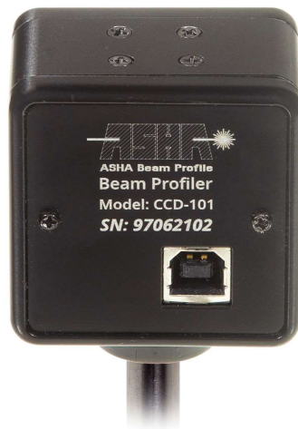
شکل ۳. حسگر نمایه‌سنج دو بعدی - نمای پشت
